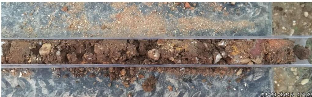
**Photo 8.** Sondage GAL\_S1 de 0 m (gauche) à 1 m (droite) de profondeur (peu de matière remontée)
