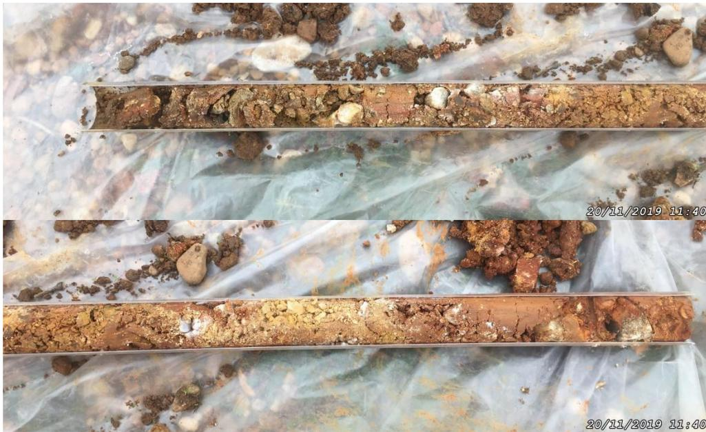
**Photo 17.** Sondage GAL\_S2 de 3 m (haut gauche) à 4 m (bas droite) de profondeur
