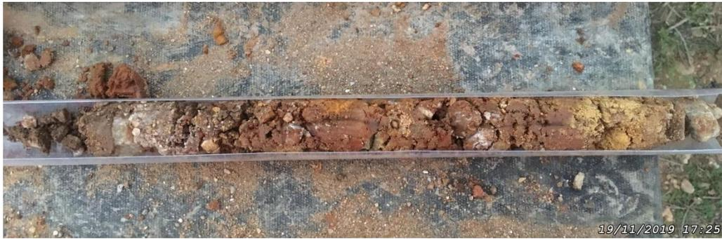
**Photo 9.** Sondage GAL\_S1 de 1 m (gauche) à 2 m (droite) de profondeur (peu de matière remontée)
