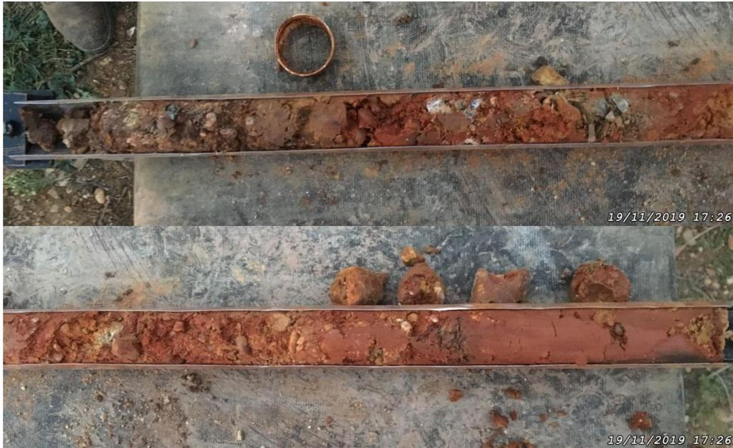
**Photo 11.** Sondage GAL\_S1 de 3 m (haut gauche) à 4 m (bas droite) de profondeur
