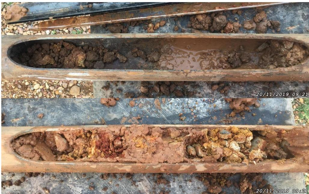
**Photo 27.** Sondage GAL\_S4 de 1 m (haut gauche) à 2 m (bas droite) de profondeur (peu de matière remontée)
