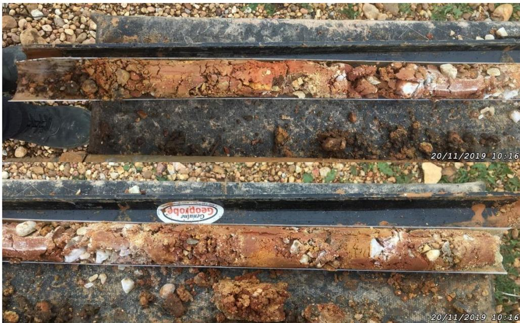
**Photo 22.** Sondage GAL\_S3 de 2 m (haut gauche) à 3 m (bas droite) de profondeur
