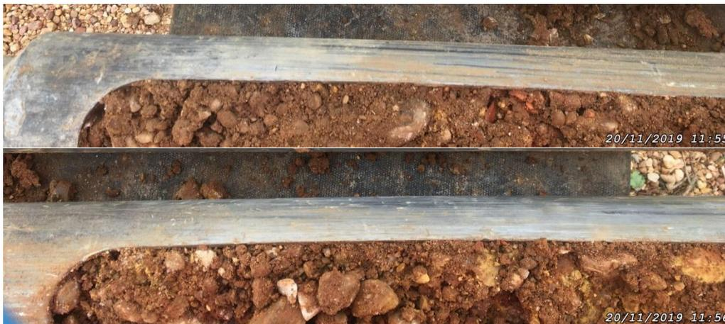
**Photo 31.** Sondage GAL\_S6 de 0 m (haut gauche) à 1 m (bas droite) de profondeur
