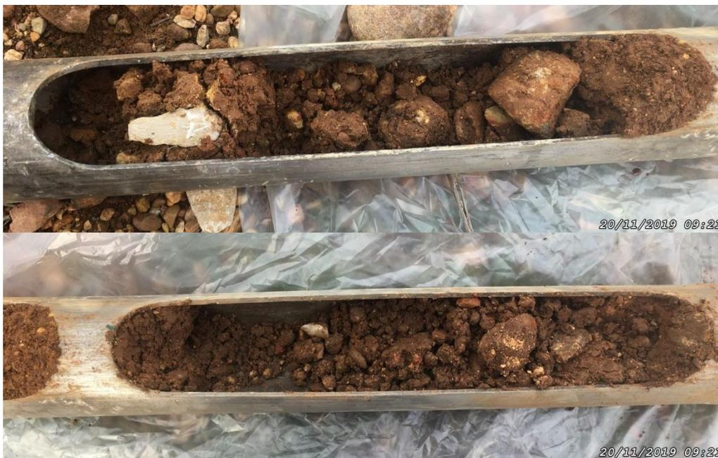
**Photo 26.** Sondage GAL\_S4 de 0 m (haut gauche) à 1 m (bas droite) de profondeur
