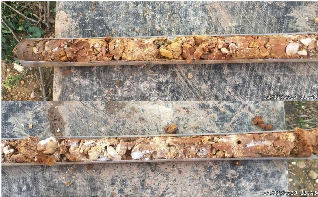
**Photo 3.** Sondage GAL\_S0 de 1 m (haut gauche) à 2 m (bas droite) de profondeur
