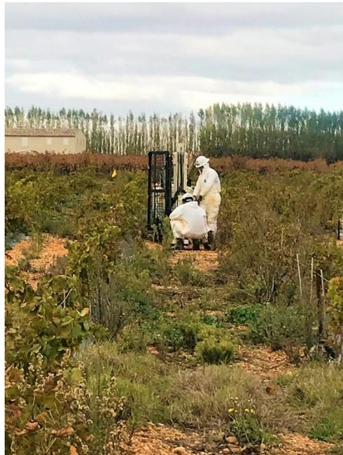
**Photo 1.** Atelier de sondage (Géoprobe) sur le site GAL9
