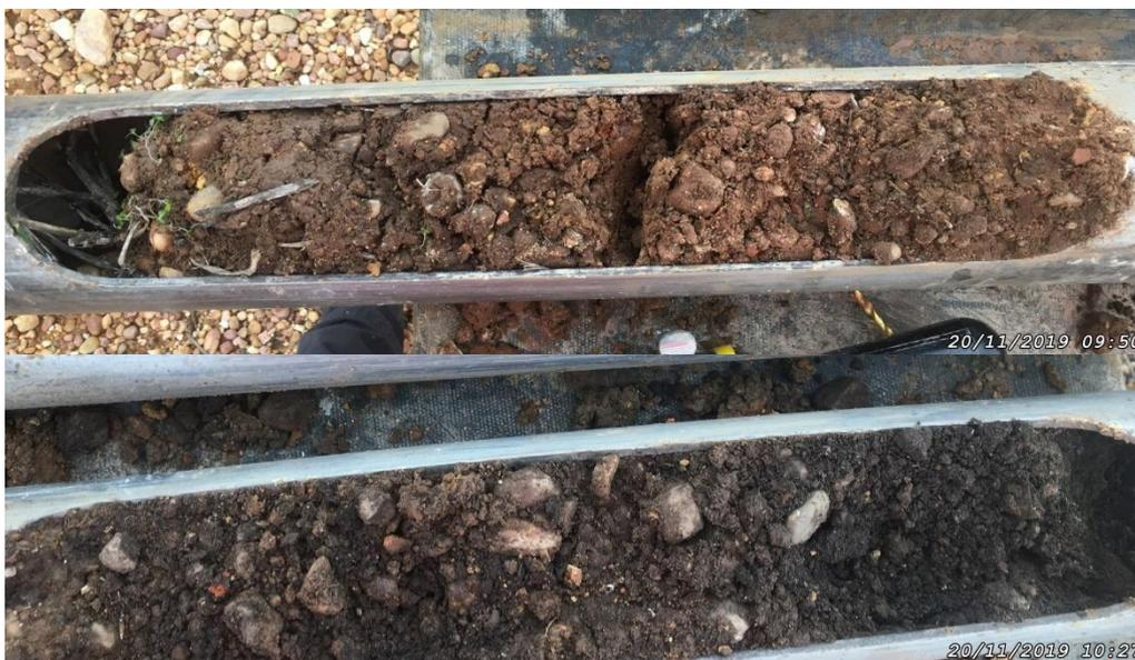
**Photo 20.** Sondage GAL\_S3 de 0 m (haut gauche) à 1 m (bas droite) de profondeur
