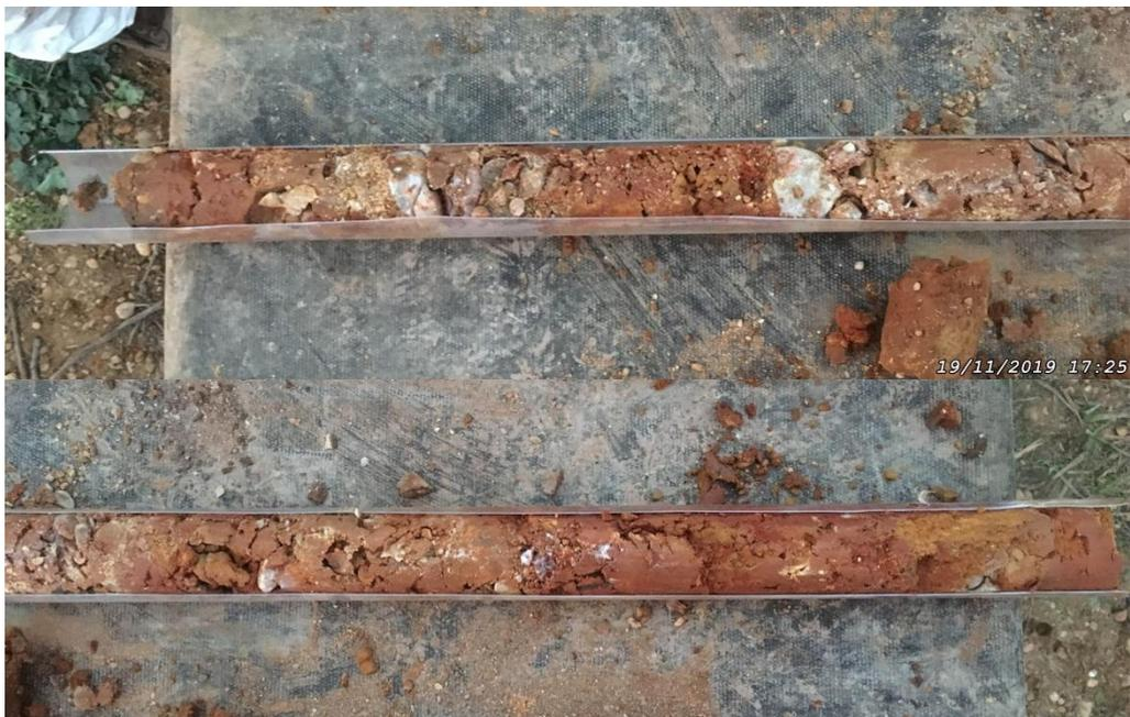
**Photo 10.** Sondage GAL\_S1 de 2 m (haut gauche) à 3 m (bas droite) de profondeur
